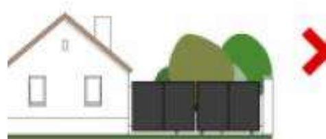
Fésűs, utcavonalas beépítésben zárt kerítés
