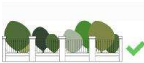
Tömör lábazatos áttört kerítés
